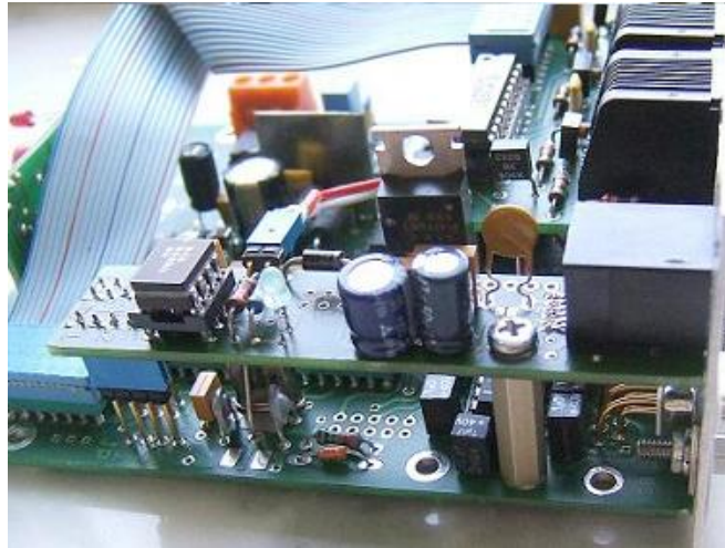
Abb. 42: eingebauter Xpressnet™ Adapter (Quelle: archiv)
