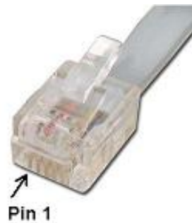
Abb. 39: Xpressnet, RJ12 Stecker (Quelle: archiv)
