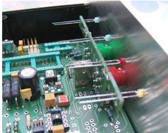
(b) Erst bei einer Probemontage im Gehäuse werden die LED in die Bohrungen der Frontplatte geschoben und verlötet. Die Frontplatine könnte gegen Durchbiegen mit einem Blech- oder Platinenstreifen entlang der blauen Linie versteift werden.
