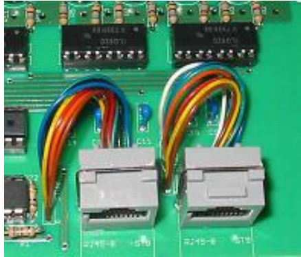
Abb. 54: Gleisbesetzmelder von Ratschmeier (Quelle: Autor)
