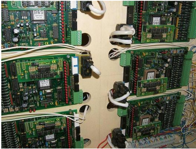
Abb. 52: Die Rückmelder (GBM16XS) der Hauptwendel mit eingesteckten Adaptern (Quelle: Autor)
