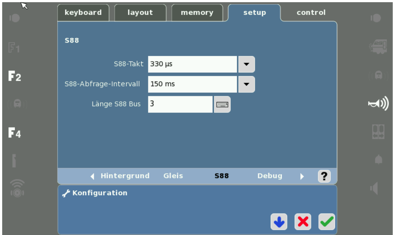
Abbildung 7: Achten Sie darauf, dass die Länge des S88 Bus definiert wird. Hier wird (mindestens) die Anzahl der angeschlossenen Rückmelde-Module eingetragen (als 16er Module, d.h. „3“ entspricht 6x MS88)
