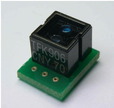
dies ist die kleinste Platine im Bunde und es gibt auch nur 1 Bauteil zu bestücken: den optischen Sensor CNY70. Auch bei diesem Bauteil ist auf die Einbaurichtung zu achten: die Schrift zeigt in Richtung der 3 Löt pads, wobei die Pads (Beschriftet mit „a“, „b“ und „c“) selber auf der anderen Seite der Platine liegen. Gelötet wird also nur auf der Seite der Platine, die beschriftet ist!
