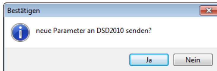
Durch Betätigung werden die Parameter zur Bühne übertragen (also die minimale Geschwindigkeiten und die Nominal-Strom Werte für jede Drehrichtung).
